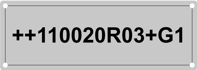
Schild am Greifer, 37 x 105 x 1,0 mm, Artikel: 2838 AE, Aluminium, silbern, matt, 4 Befestigungslöcher (Ø 2,6 mm)
