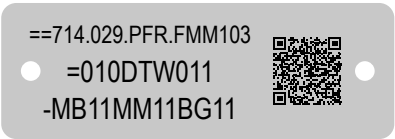
Kennzeichnungsschild elektrische Betriebsmittel, 18 x 52 x 0,5 mm, Artikel: 1376 AE, Aluminium, silbern, matt, 2 Befestigungslöcher (Ø 2,8 mm)
