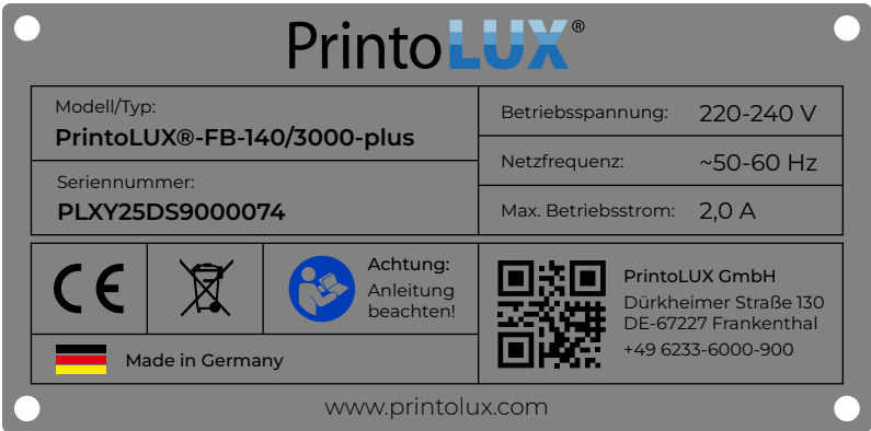
Typenschild, 52 x 105 x 1,0 mm, Artikel: 2726 VE, Edelstahl, silbern, glänzend, 4 Befestigungslöcher (Ø 3,1 mm)
