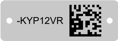
Beschriftung der Betriebsmittel, 18 x 52 x 0,5 mm, Artikel: 1376 AE, Aluminium, silbern, matt, 2 Befestigungslöcher (Ø 2,8 mm)
