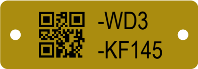
Beschriftung der Betriebsmittel, 18 x 52 x 1,0 mm, Artikel: 755 ME, Messing, golden, glänzend, 2 Befestigungslöcher (Ø 2,8 mm)
