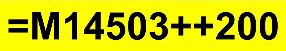
Bezeichnungsschild für Klemmenkästen und Prozessgeräte, 45 x 250 x 0,4 mm (Abb. Maßstab 1:2), Artikel: 1468 PD, Polyesterdekorfolie, gelb, matt, selbstklebend, stark haftend
